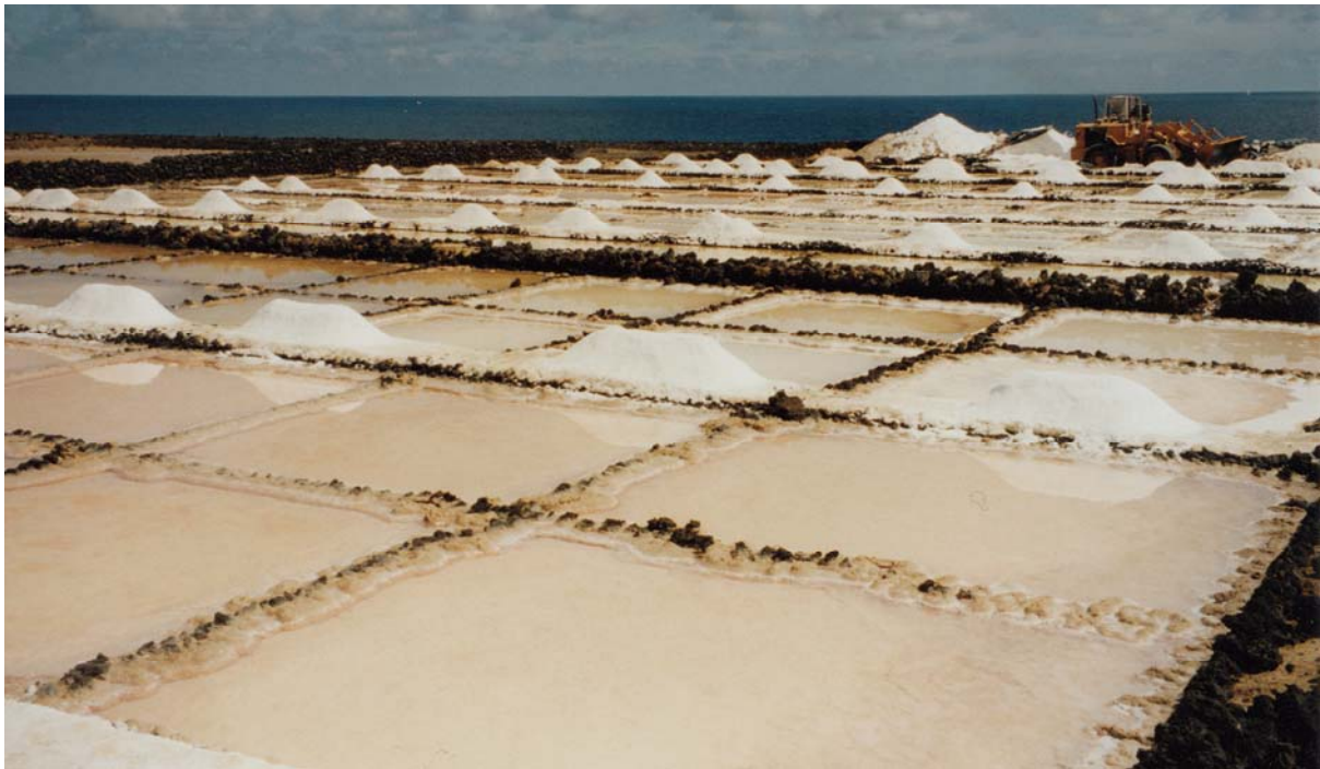
Abb. 3: Saline Los Cocoteros (Lanzarote, Spanien). In einem mehrstufigen Prozess wird Meerwasser auf dem Weg durch mehrere Becken zu einer Salzlake reduziert, aus der sich durch weitere Verdunstung schließlich verhältnismäßig reines Steinsalz abscheidet. Feststoffe und schlechter lösliche Salze wie Dolomit und Gips werden bereits in vorgelagerten Verdunstungsbecken ausgefällt, während in dem Prozessschritt, der zur Steinsalzkristallisation führt, eine bestimmte Konzentration der Lake nicht überschritten werden darf, um das Ausfällen des besser löslichen, unerwünschten Sylvins (Kaliumchlorid, KCl) zu vermeiden. Unter diesen kontrollierten, in der freien Natur nur selten anzutreffenden Bedingungen entstehen gut ausgebildete Halitwürfel auf der Sedimentoberfläche.
