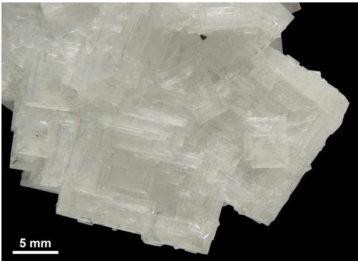
Abb. 7: Halitkristalle aus der Saline von Walvis Bay. Oben: Handstück mit großen „Würfeln“ (Kantenlänge bis 1,7 cm). Unten: Detail des Handstücks. Bei näherer Betrachtung zeigen sich die großen „Würfeln“ als Skelettkristalle und orientierte Verwachsungen mehrerer kleiner Würfel. Die Bedingungen waren nicht zur Ausbildung echter großer Halitwürfel geeignet.
